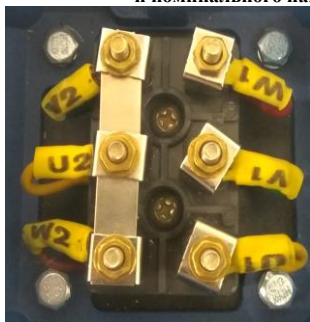
Рис.3. Соединение обмоток мотора по схеме «звезда»
