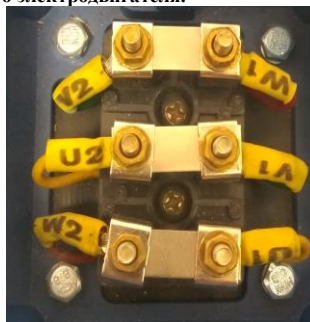
Рис.4. Соединение обмоток мотора по схеме «треугольник»
